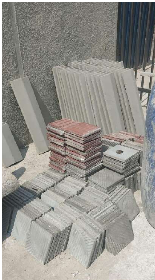
Piso em ladrilho hidráulico
